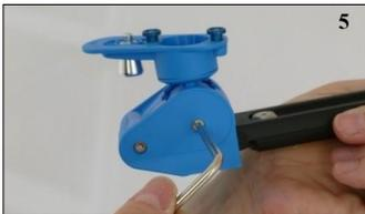
5. Appuyer de nouveau fermement sur les moitiés du logement et resserrer les vis.
