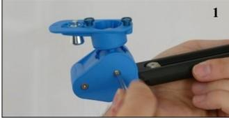
1. Desserrer les deux vis maintenant les deux moitiés du logement du rotor de deux tours complets (avec la clé Torx T 10).
