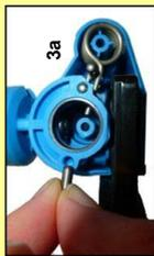
3. Insérer la cheville d'arrêt jusqu'à la butée dans le trou prévu à cet effet dans la partie inférieure du rotor.
