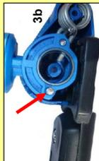
4. Refermer le logement du rotor. La cheville d'arrêt s'engage dans le trou prévu à cet effet dans le logement du rotor.
