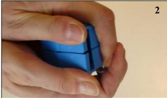
2. Puis, séparer le logement du rotor par la partie inférieure en créant un interstice.
