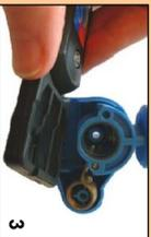
3. Tire de la carcasa del rotor para extraerla de la férula.
