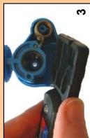
4. Odvignite metalnu iglu 1 smještenu između krakova opruge. Uklonite potom oprugu. U istom momentu se otpušta i unutarnji dio rotora.
