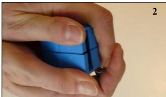
2. Nakon toga kućište rotora s donje strane razmagnite za širinu pukotine.
