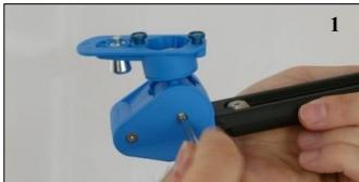
1. Odvrnite oba vijka koji drže dvije polovice kućišta rotora za dva puna kruga (torx ključem T 10).
